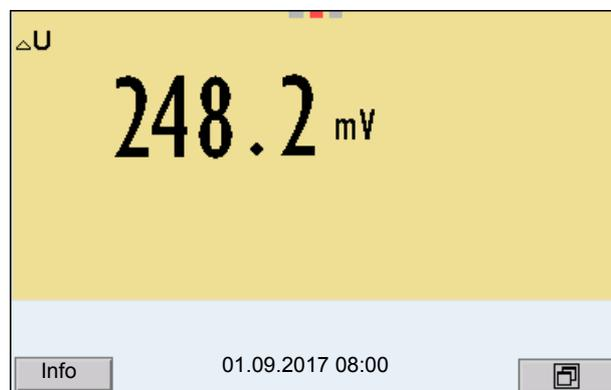
**AutoRead** Die Funktion *Stabilitätskontrolle* überprüft, ob die Messwerte in dem überwachten Zeitintervall stabil sind.
