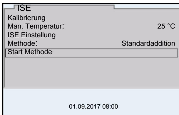
9. Mit **<▲>** **<▼>** *Start Methode* markieren und mit **<ENTER>** bestätigen. Die Messung mit der gewählten Methode beginnt (siehe Abschnitt 7.3.1 STANDARDADDITION, Seite 58 ... Abschnitt 7.3.5 STANDARDADDITION MIT BLINDWERTKORREKTUR (BLINDWERTADDITION), Seite 68).
