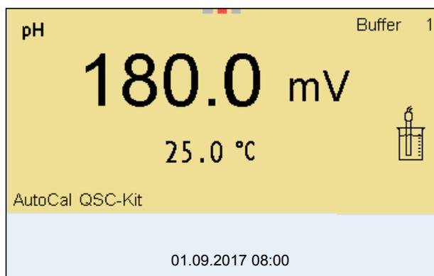
3. Die Kalibrierung mit den Puffern des QSC-Kit verläuft wie eine reguläre Dreipunktkalibrierung. Folgen Sie der Benutzerführung.
