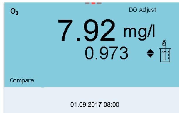
6. Mit **<▲>** **<▼>** den Korrekturfaktor so einstellen, dass der angezeigte Konzentrationswert dem Sollwert (Wert der Vergleichsmessung) entspricht. Anschließend Korrekturfaktor mit **<ENTER>** übernehmen.
